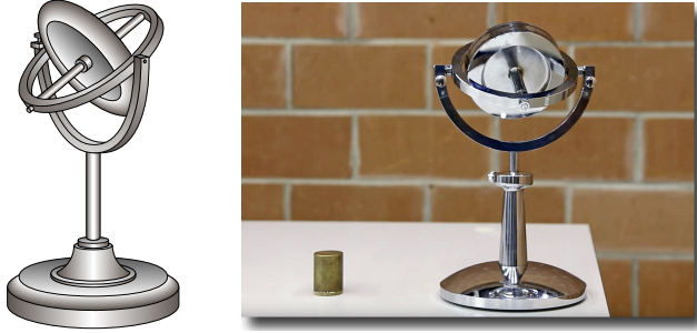
FIGURE 13.6 Gyroscopie constitué d'un disque en rotation autour d'un axe dont l'orientation ne change pas lors d'une rotation des deux cadrans concentriques sur lesquels l'axe du disque est monté. Les axes de rotation des cadrans sont orthogonaux et ils passent par le centre de masse du disque.
