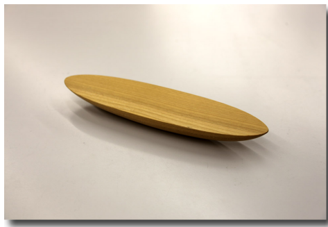
FIGURE 13.12 Anagyre dont le mouvement de précession n'est stable que dans un seul sens de rotation.
